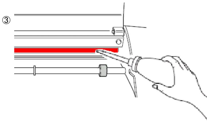
左図のシャフト部分へ機械油を少量塗布します。油が多すぎると、油が垂れてシートを汚すことがあります。
